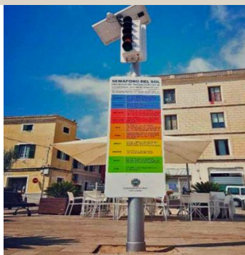
Figura 8. “Semáforo” con indicación mediante código de radiación ultravioleta.
